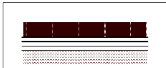
Figura 9.2: Hidroizolimi me shirita bituminozë të ngjitur/të shkrirë Për të evituar ngjeshjen e bitumit dhe dëmtimin e tij për shkak të pjesës së tepërt të materialit lidhës në shtresat e mbindërtuara të përzierjes bituminoze, pjesa e vijave të bashkimit duhet të mbulohet me një shirit të përshtatshëm për lidhje, afërsisht 200 mm të gjerë. Lidhja e këtyre shiritave me bazën duhet të sigurohet nëpërmjet një nxehtë të kujdesshme të pjesëve të vijës së bashkimit. Mbivendosja e shiritave për fashimin duhet të rritet në të paktën 50 mm.
