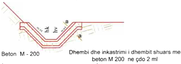
SEKSION TERTHOR TIP (Ne zonat me shuares energjie) PRRJE TERTHORE E KANALIT SH. 1:50
