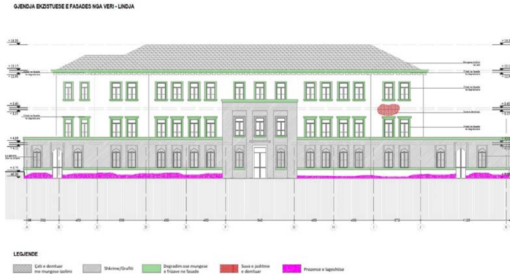
Figure 24 Dëgradimet në fasadën balllore të Shkollës "Asim Zeneli"
